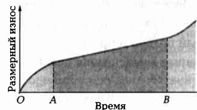
Рис. 4.25. Кривая, характеризующая протекание размерного изнашивания инструмента во времени
