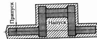
Рис. 7.2. Заготовка коленчатого вала, выполненная с напуском
