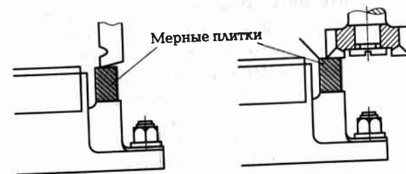
Рис. 4.18. Использование плоскопараллельных концевых мер (плиток) для статической настройки размерных цепей технологической системы
