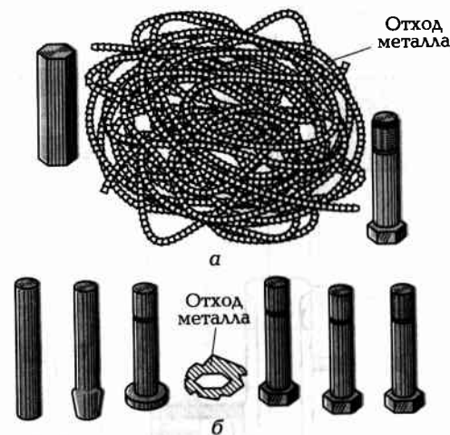
Рис. 5.4. Сравнительное количество отходов металла при изготовлении болта на токарном автомате (а) и методами холодной высадки с последующей накаткой резьбы (б)
