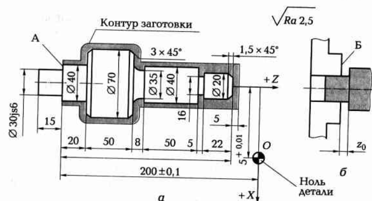
Рис. 2.16. Схема для определения нуля детали (а, б)
