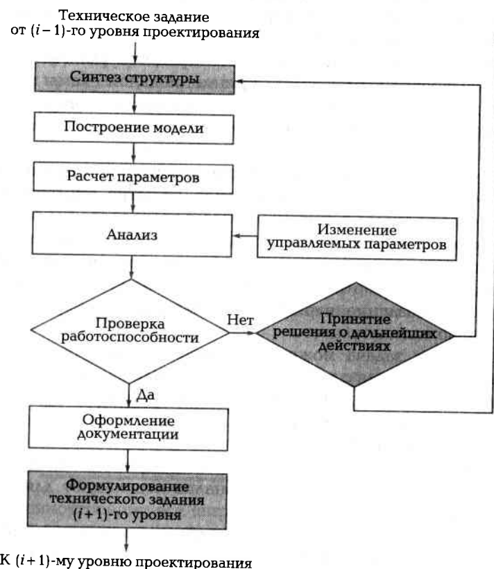
Рис. 4.1. Схема процесса проектирования на i -м уровне
